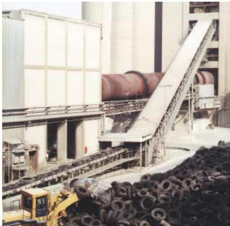
Zuführung von Altreifen in den Drehrohrofen
